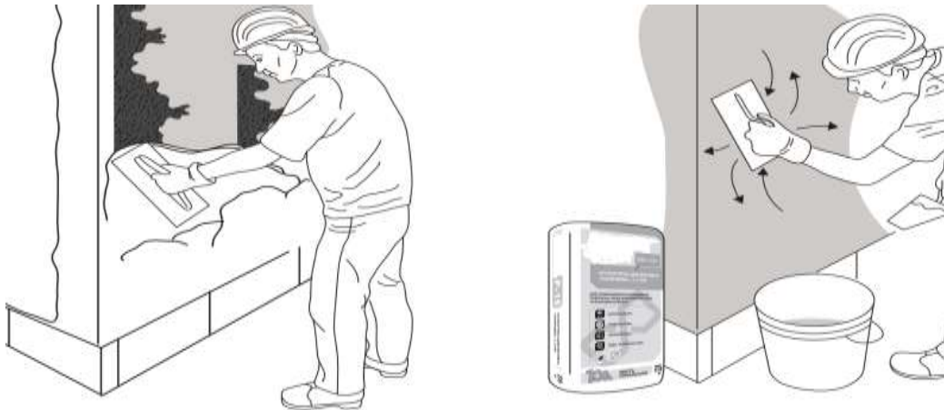
Малюнок 86(нанесення декоративно-захисного шару)
