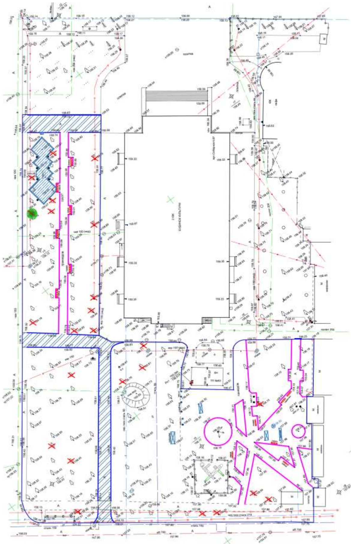
Рисунок 12 – План демонтажу існуючих конструкцій та покриття парку
