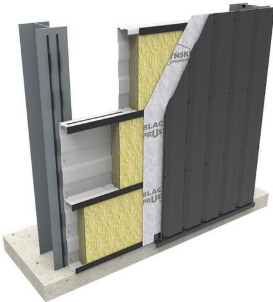
Рис. 2.1 – Загальний вигляд стіни з збірної сандвіч панелі
