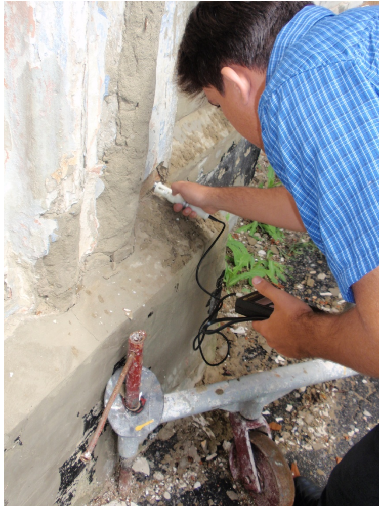
Рис. 2.7 – Визначення марки цегли зовнішніх огорожувальних конструкцій учбового корпусу Полтавського обласного центру науково-технічної творчості учнівської молоді ПОР.
