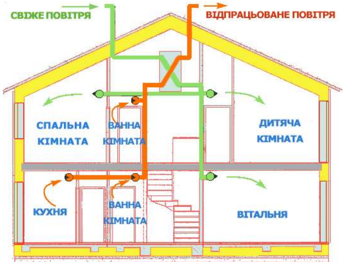
Рис.1.8-Принцип вентиляції пасивного будинку ( https://passivehouse-igua.com/passive-house/ventilation-of-airtight-passive-house/ )
