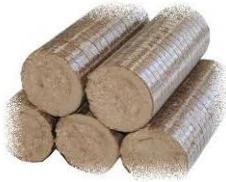
Рисунок 1.7. Пелети, виготовлені на ударно-механічних пресах
