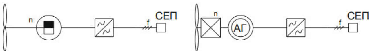
Рисунок 2.12 – Підключення ВЕУ до мережі за допомогою перетворювача частоти з (а) синхронним (без механічної передачі) і (б) асинхронним генератором
