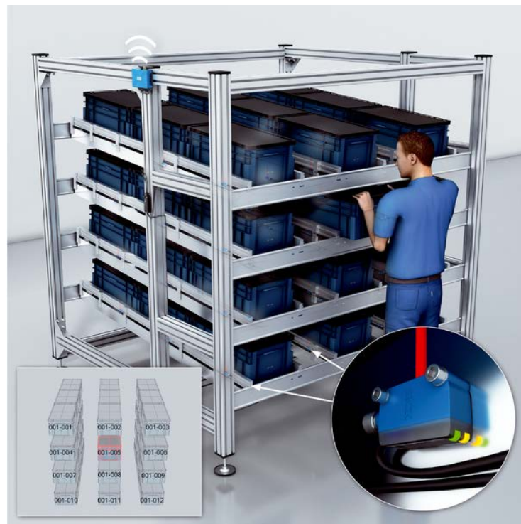
Рисунок 3.9 – Автоматизоване повторне замовлення матеріалу на стелажах за системою E-Kanban
