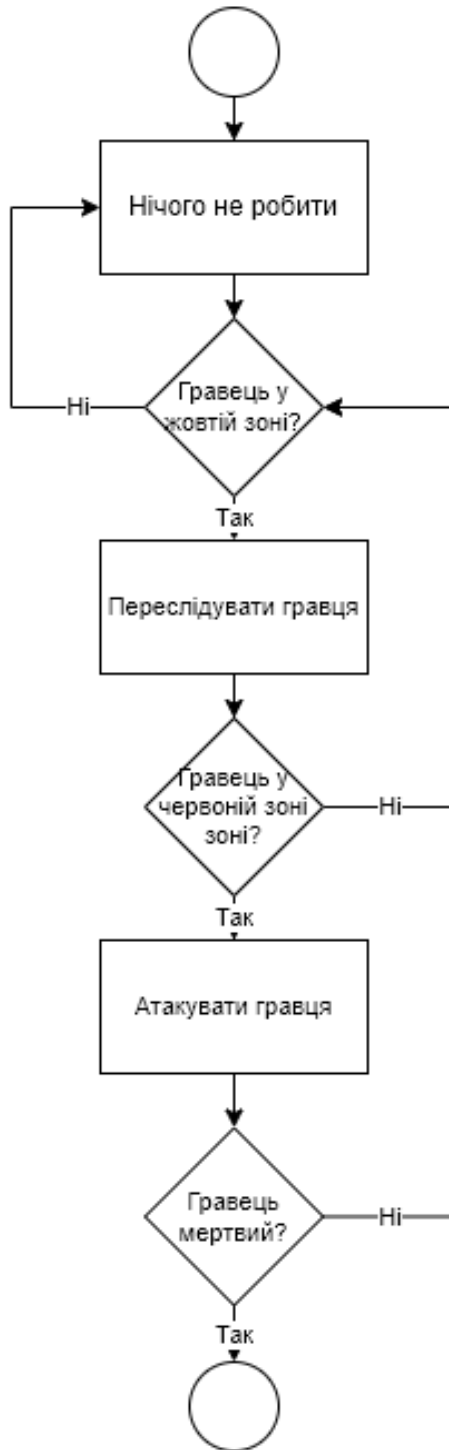
Рисунок 2.11–Блок-схема роботи штучного інтелекту ворогів
