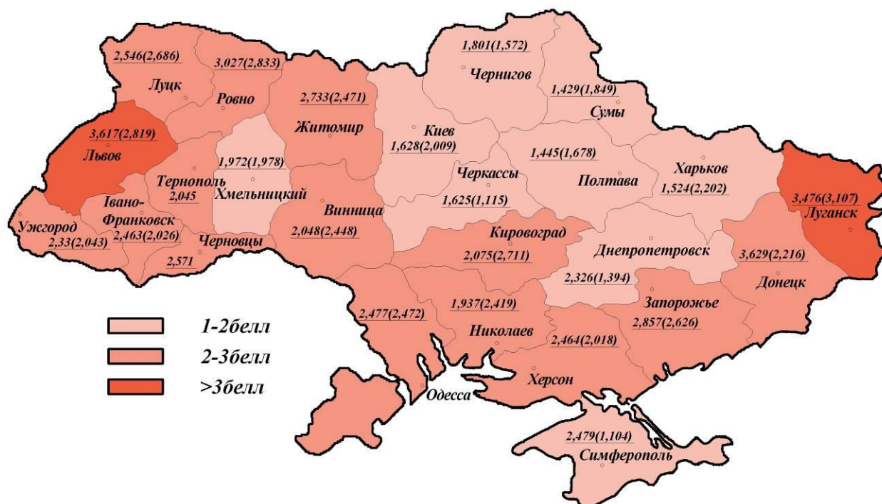
Рис. 4.23. Територіальна оцінка показника надійності P_L конструкцій, що сприймають постійне та снігове (частка впливу C_1 = 0,7 ) навантаження
