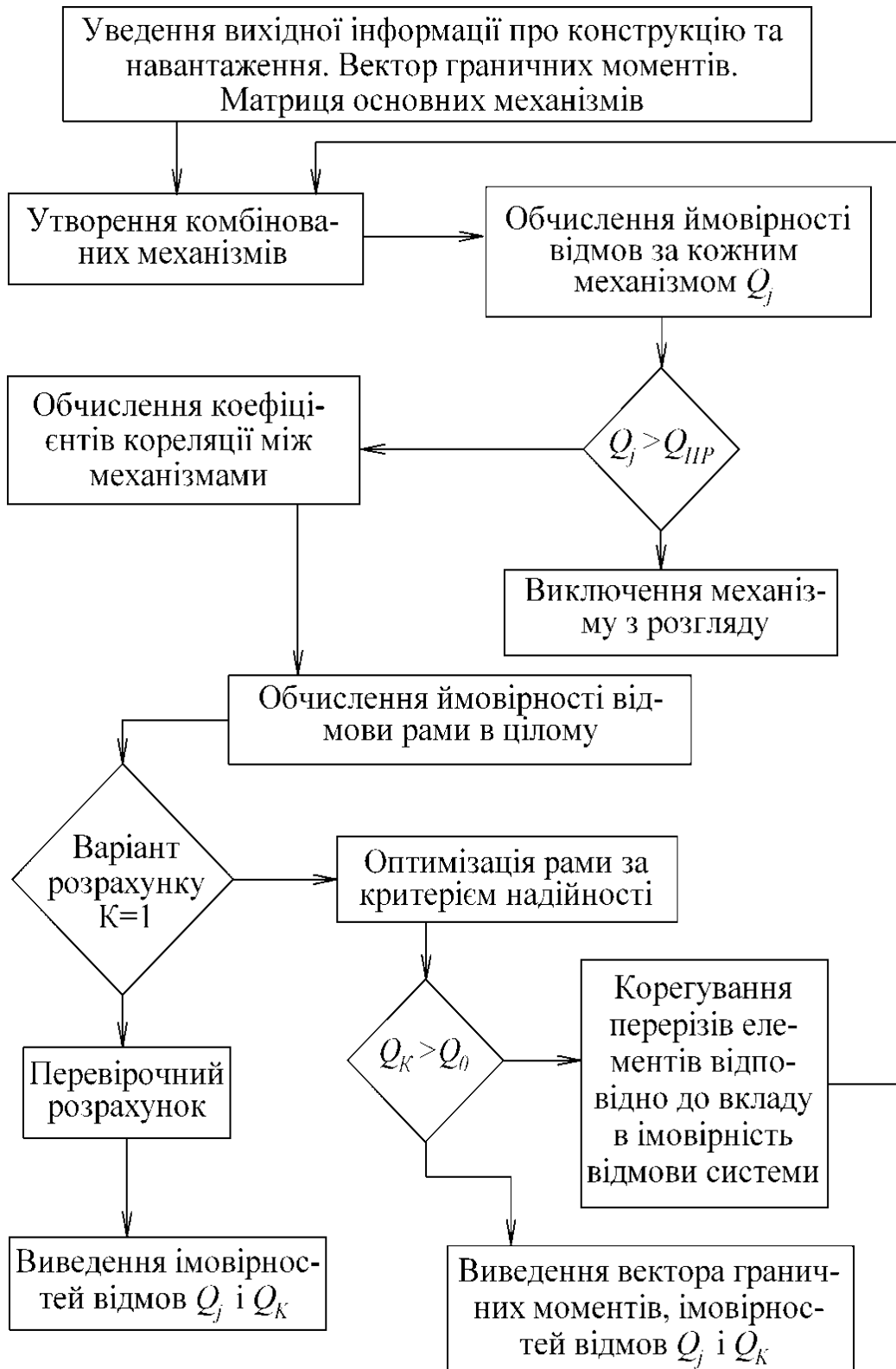
Рис. 6.13. Блок-схема розрахунку рам імовірнісним методом комбінованих механізмів
