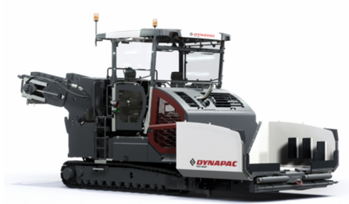
Рисунок 5 – Самохідний перевантажувач «Дунарас MF2500»
