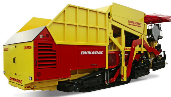
Рисунок 6 – Самохідний модульний укладальник «Дунарас CM2500»
