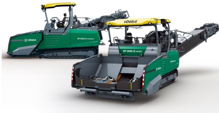
Рисунок 2 – Самохідний перевантажувач «Vögele PowerFeeder»
