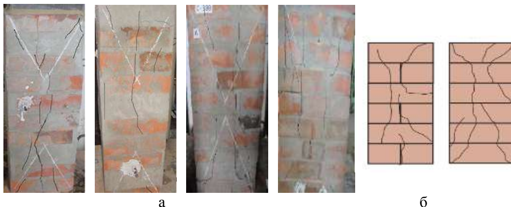
Рис. 1 – Характер руйнування дослідних стовпів з поперечним перерізом 250x250 мм і 380x380 мм (а) та призм (б)
