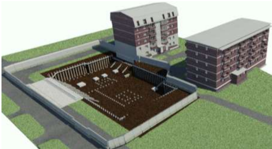
Рис. 1 – Просторова модель ситуації влаштування котловану в існуючій забудові
