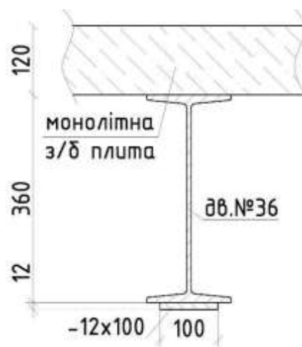
Рис. 2 – Геометрія комбінованого сталезалізобетонного перерізу
