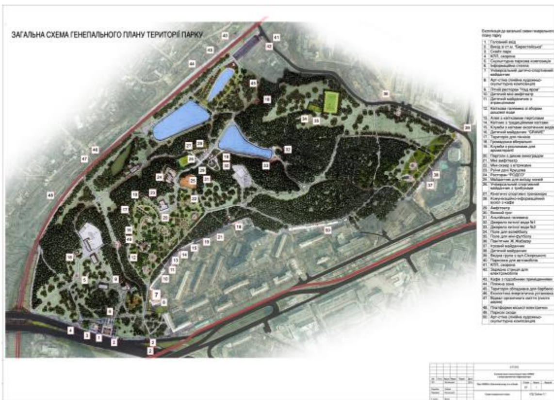
Рис.2. Ескіз генерального плану на основі масштабованого рисунку (для замовника). Калька поверх геодезичної зйомки (М 1:1000) та аерофотозйомкою від Google; лайнери, кольорові маркери, опрацювання в програмі Adobe Photoshop, переведення в креслення в програмі ArchiCAD
