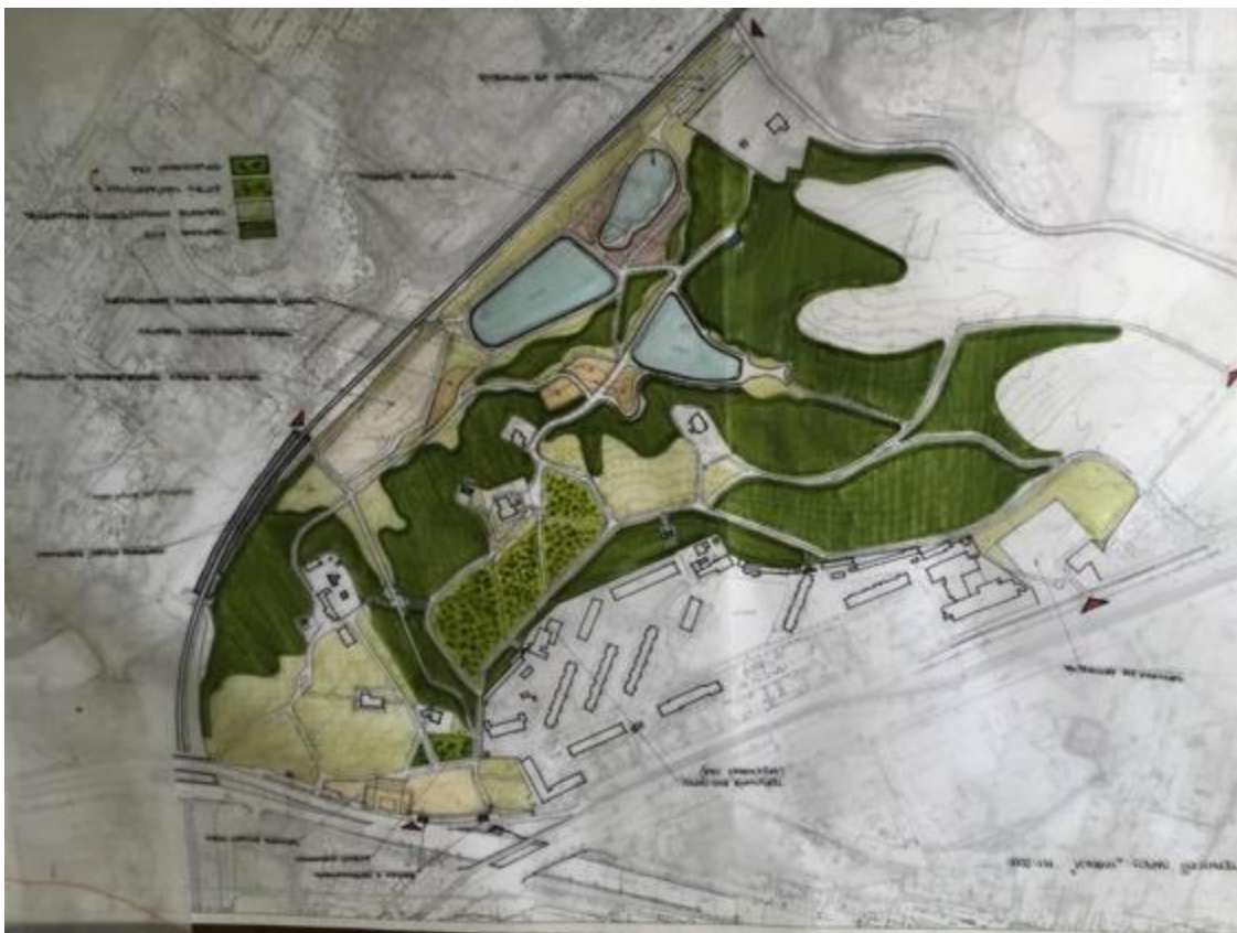
Рис.1. Ескіз ідеї генерального плану (для себе). Калька поверх геодезичної зйомки (М 1:2000), лайнери, кольорові маркери
