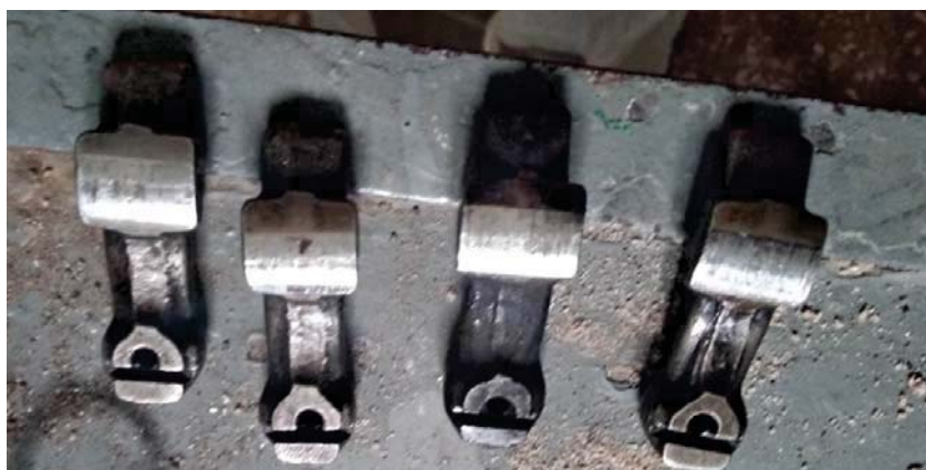
Рисунок 1 – Зношування поверхонь тертя деталей механізму газорозподілу двигуна внутрішнього згоряння
