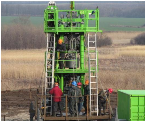
Рис. 1 Снаббінгова установка Snubbertech SIL-190-4 . https://www.nefterynok.info
