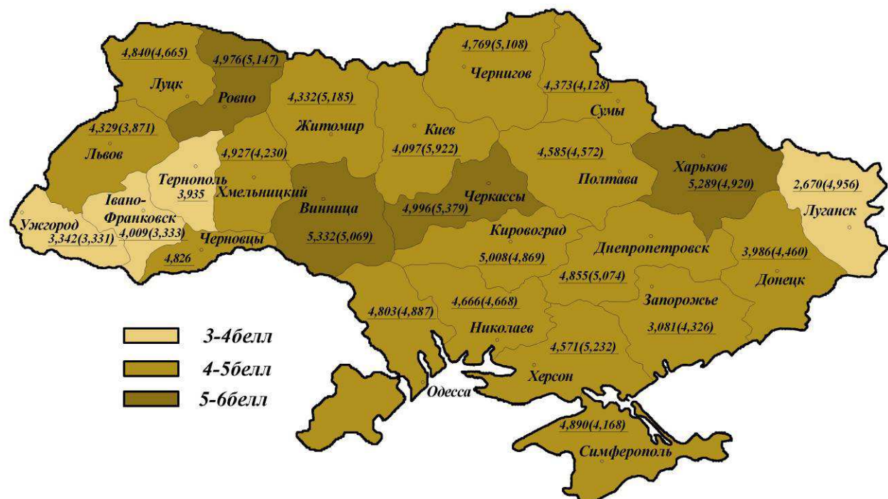
Рис. 3.25. Територіальна оцінка показника надійності P_L конструкцій, що сприймають постійне та вітрове (частка впливу C_2 = 0,7 ) навантаження
