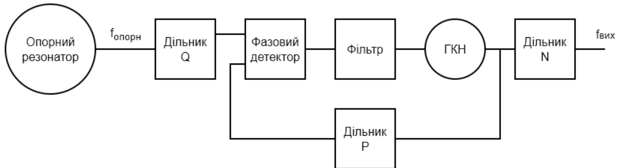
Рис. 1. Блок-схема ФАПЧ (ГКН – генератор, керований напругою)
