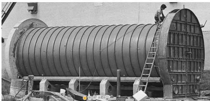
Рисунок 4 – Спірально-фальцевий горизонтальний ферментер ( https://xaver-lipp.com/. )
