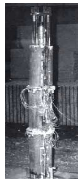
Рис. 1.29 – ТБЕ з попередньо обтиснутим ядром [190]
