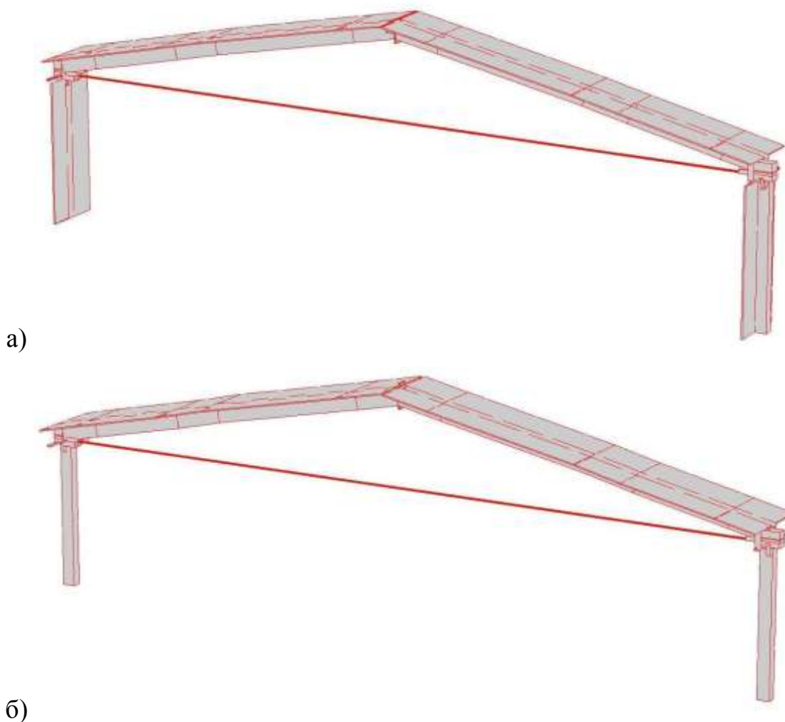
Рис. 6.21 – Схематичне зображення прийнятих для розрахунку перерізів (жорсткостей) стінових та покрівельних панелей: а) набір №1; б) набір №9
