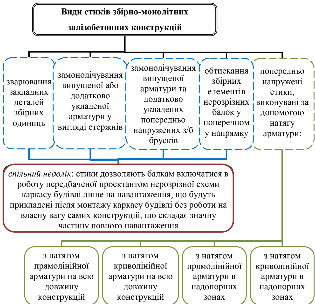
Рис. 1.34 – Класифікація стиків збірно-монолітних залізобетонних конструкцій для забезпечення їх нерозрізної статично невизначеної роботи [51]
