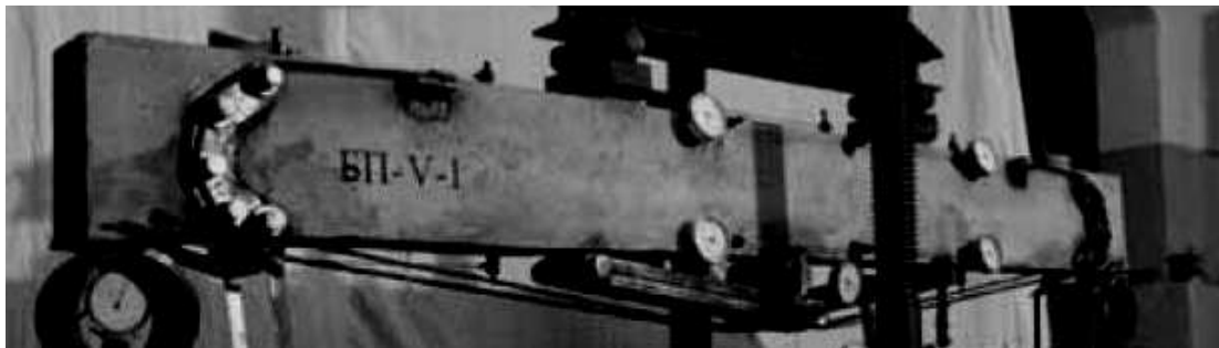
Рис. 1.4 – Вигляд з/б балки, підсиленої стрижнево-котковою системою [194]
