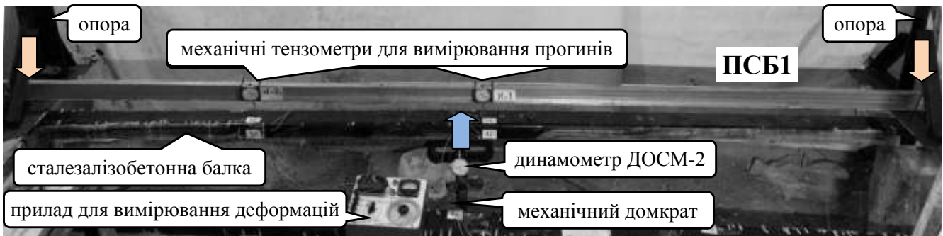
Рис. 4.23 – Загальний вигляд сталобетонних зразків під час випробувань
