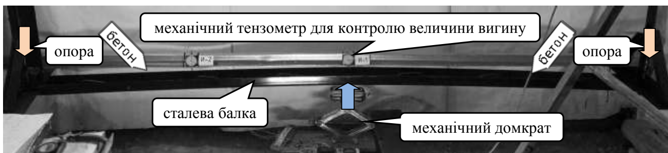
Рис. 4.21 – Попередній вигин сталеві частини перерізу балок серії ПСБ1 і ПСБ2
