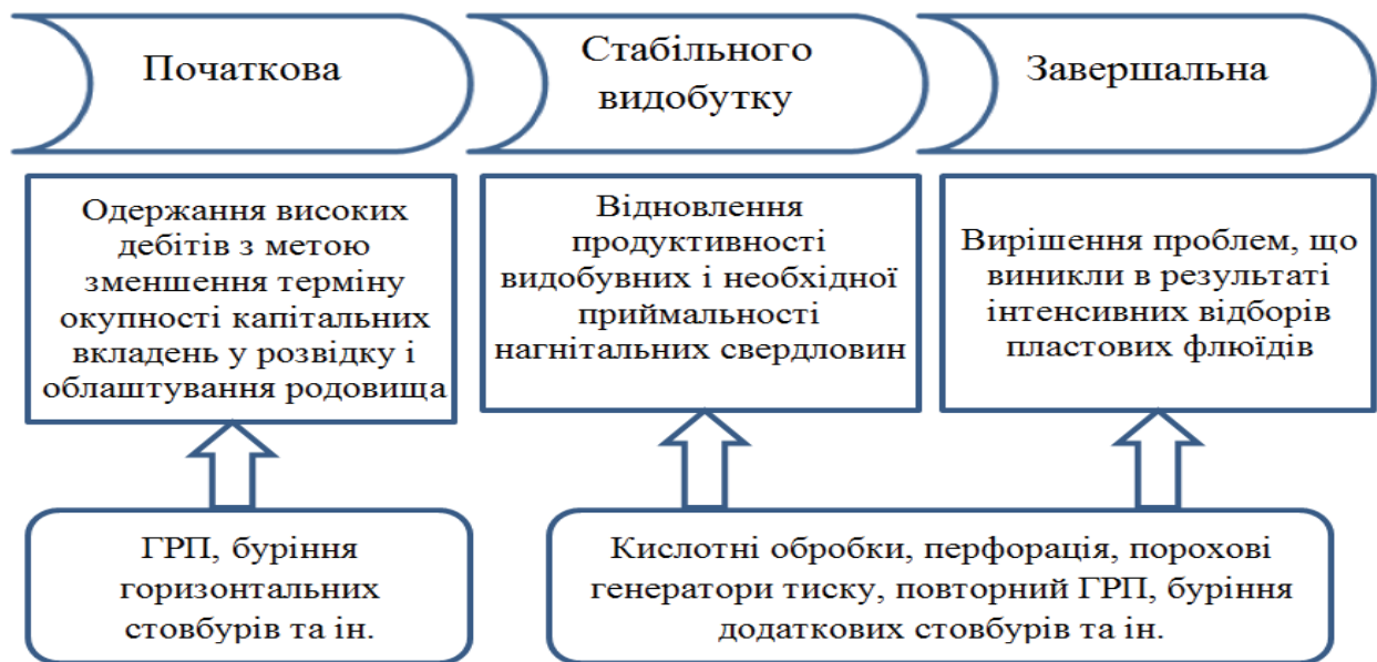
Рис. 1. Основні проблеми нафтогазовидобувної компанії в залежності від стадії розробки родовища і доступні технології ПНП, що сприяють їх вирішенню
