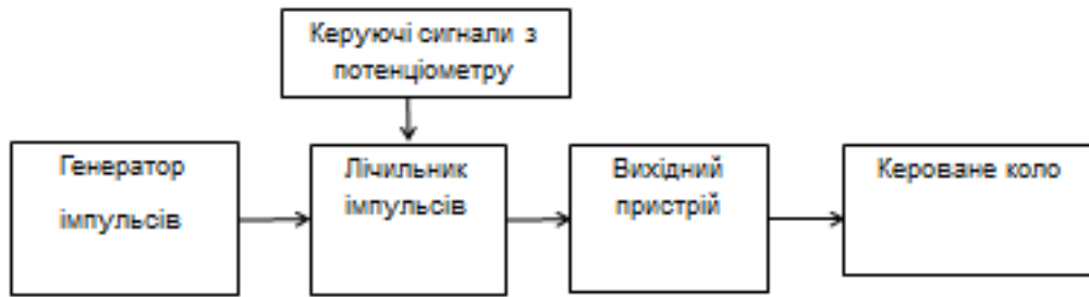
Рис. 4.6. Структурна схема електронного реле часу
