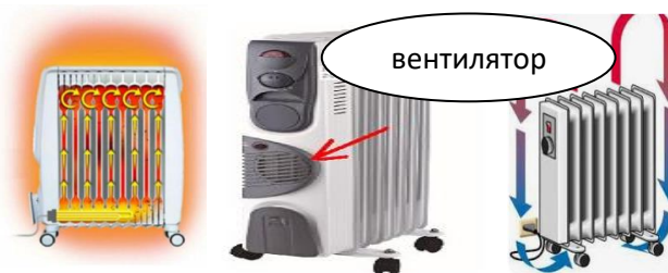
Рис. 4. Масляні радіатори, схема циркуляції оливи й ілюстрація конвективних потоків повітря
