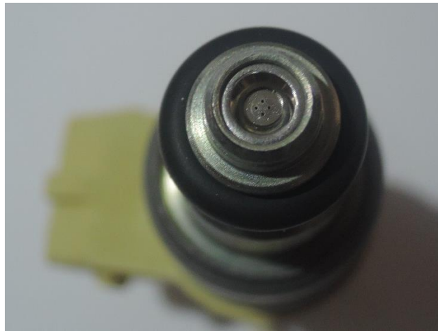
Рис. 2. Вигляд на форсунку з боку запірної голки
