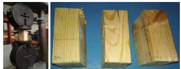
а) б) Рис. 1. а – Загальний вигляд випробування на стиск деревини; б – Вигляд дослідних зразків після руйнування
