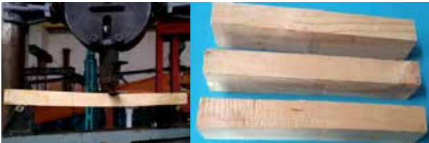
Рис. 2. а – Загальний вигляд випробування на згин деревини; б – Вигляд дослідних зразків після руйнування
