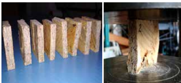
Рис. 12. Руйнування зразків п'ятої та шостої серії
