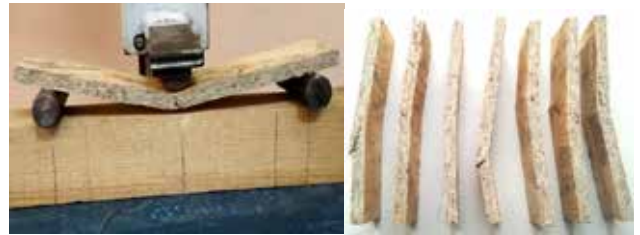
Рис. 6. Руйнування зразків першої і другої серії
