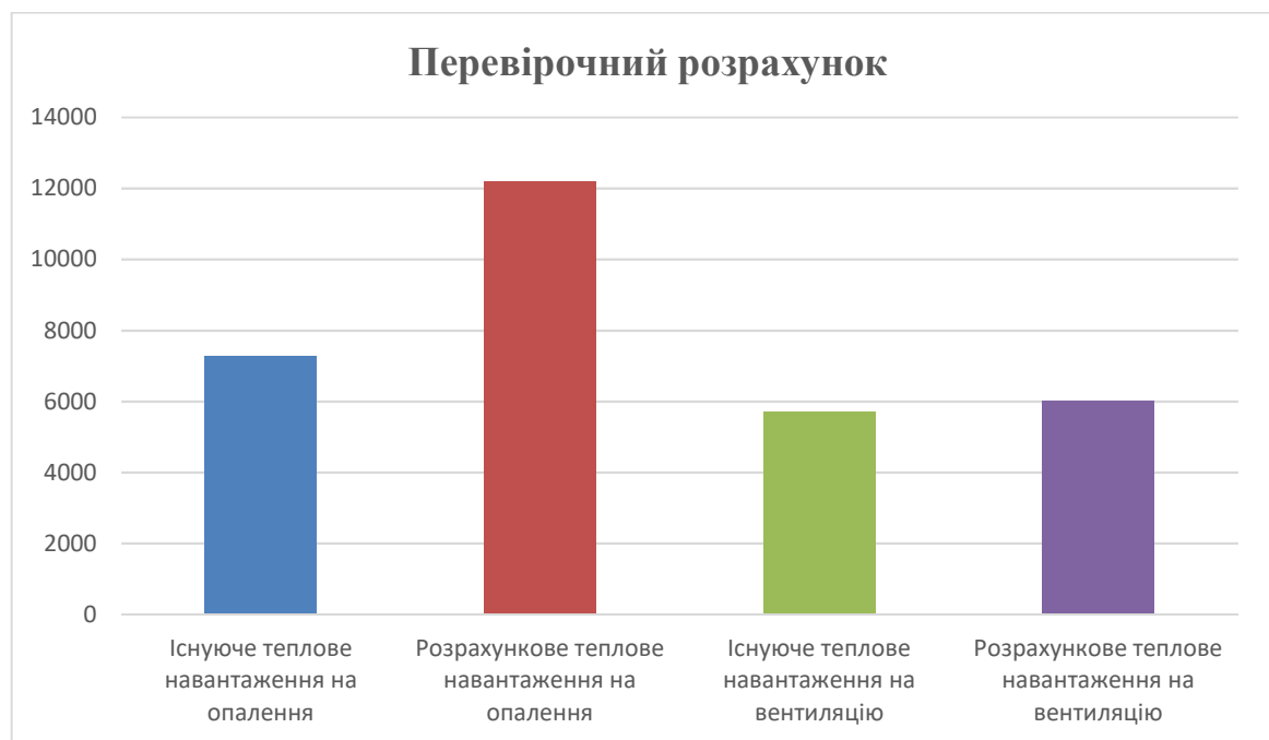
Рисунок 31 – Перевірочний розрахунок систем тепlopостачання
