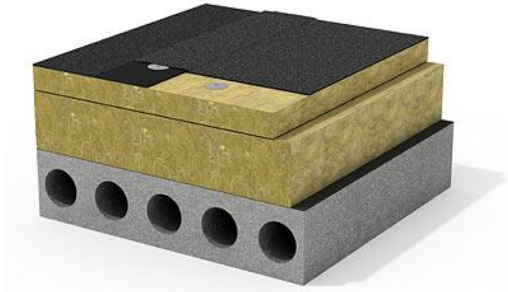
Рис. 8.4 Схема утеплення суміщеного перекриття
