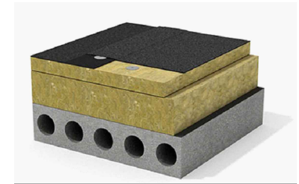
Схема утеплення суміщеного перекриття (збільшення опору теплопередачі у 4,2 рази)
