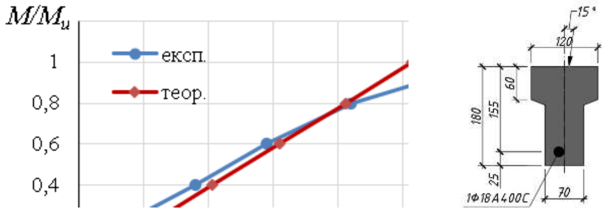
Рисунок 5.19 – Графіки збільшення відносних деформацій найбільш стиснутої фібри зразка балки БТ-3-2 залежно від рівня навантаження за даними експериментальних та теоретичних досліджень (табл. 4.1, рис. 4.12, в)
