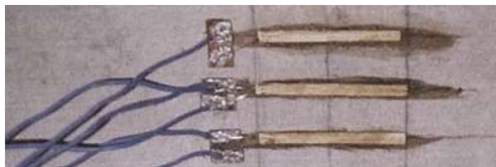
Рисунок 4.7 – Розташування тензодатчиків на поверхні бетону
