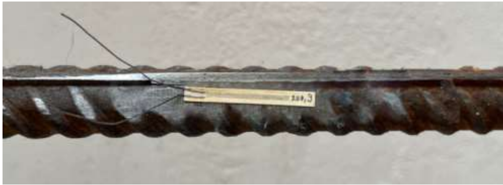
Рисунок 4.5 – Розташування електротензодатчика на стержні арматури
