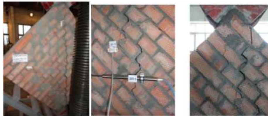
Рис. 5.15 – Характер руйнування дослідних зразків при дії статичного навантаження: а – загальний вигляд; б – тріщини в центральній частині зразка; в – тріщини в опорній зоні
