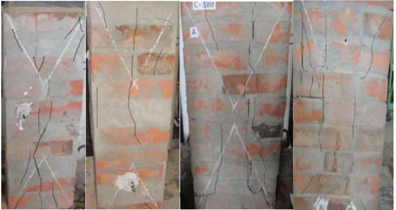
Рисунок 4.6 – Характер руйнування дослідних зразків
