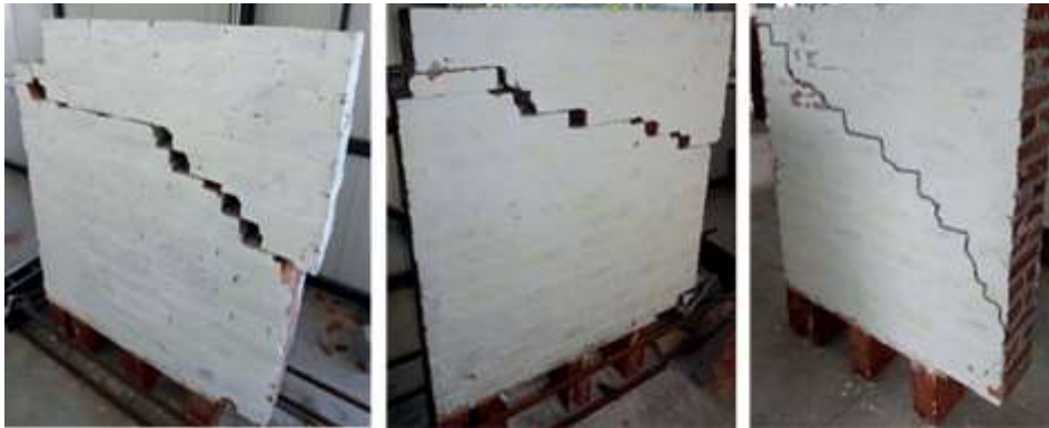
Рисунок 1.13 – Руйнування невідсилених зразків
