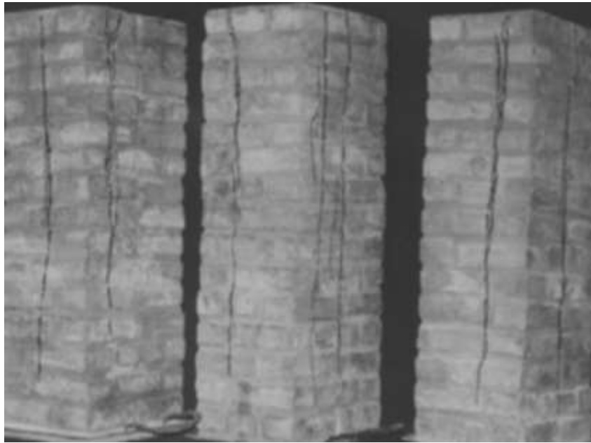
Рисунок 4.7 – Характер руйнування цегляних стовпів-призм [45]
