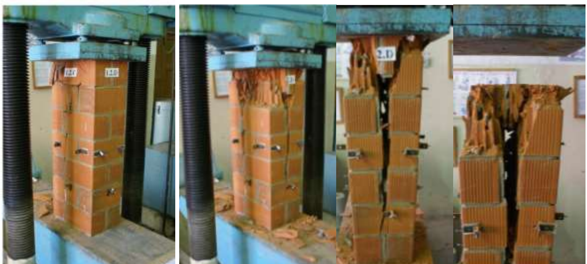
Рисунок 4.10 – Характер руйнування цегляних стовпів із керамічних каменів
