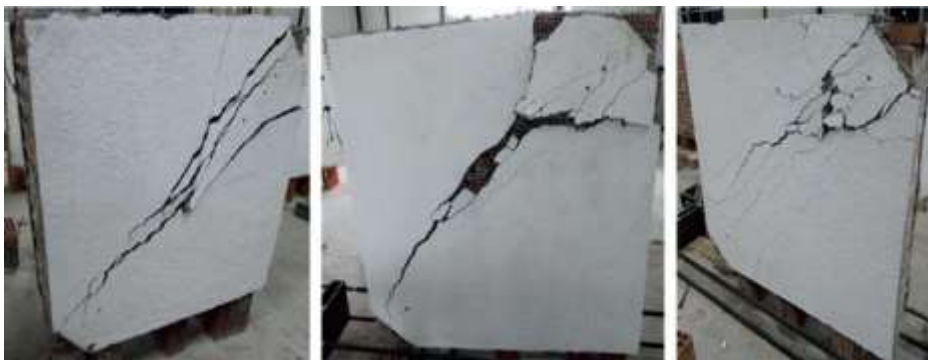
Рисунок 1.14 – Характер руйнування підсилених сітками зі скловолокна зразків
