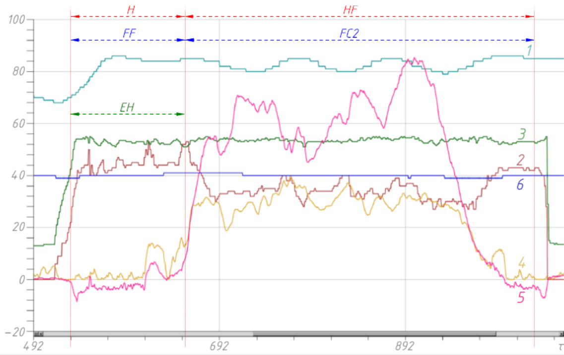
Рис. 3. Визначення ефективності CO з вентиляторами SPAL в умовах жаркого клімату 02 вересня (1-ий політ, початок): \tau – час, хв.; H – висіння; HF – горизонтальний політ; FF – робота вентиляторів на повну потужність; FC2 – циклічна робота вентиляторів на другому ступені охолодження; EH – нагрівання двигуна при висінні та перехід до режиму усталеної теплової рівноваги:
