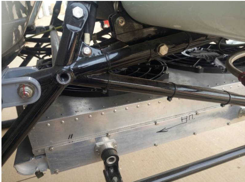
Рис. 2. Зібраний та встановлений на гелікоптер дослідний зразок нової СО з вентиляторами SPAL
