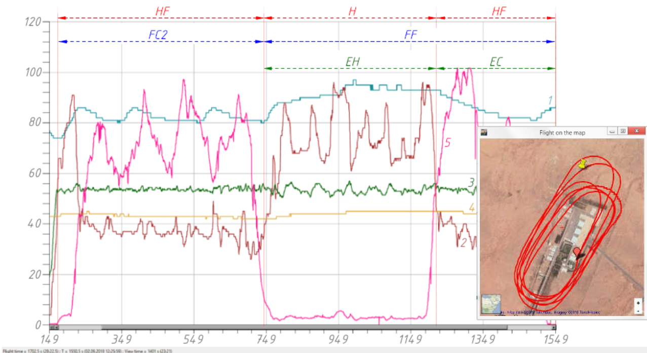
Рис. 4. Визначення ефективності CO з вентиляторами SPAL в умовах жаркого клімату 02 вересня (2-ий політ): EC – охолодження двигуна в горизонтальному польоті
