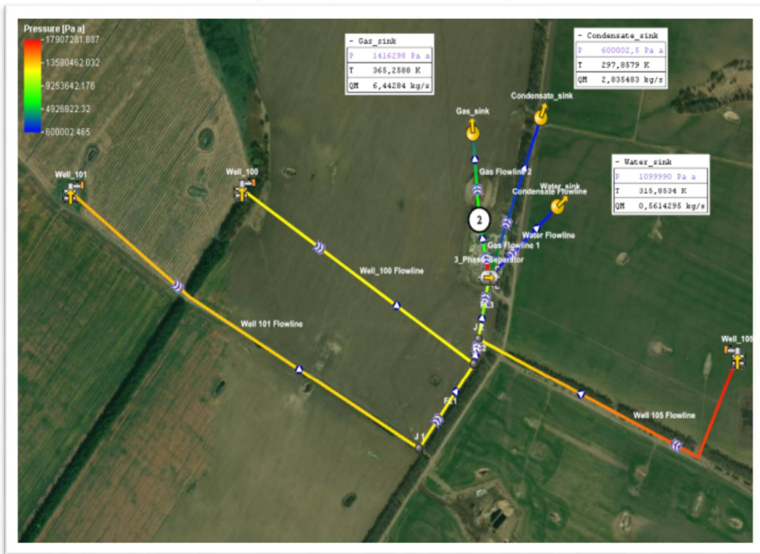
Рис. 5 Розподіл тиску в міжпромислових трубопроводах свердловин №100, №101, №105
