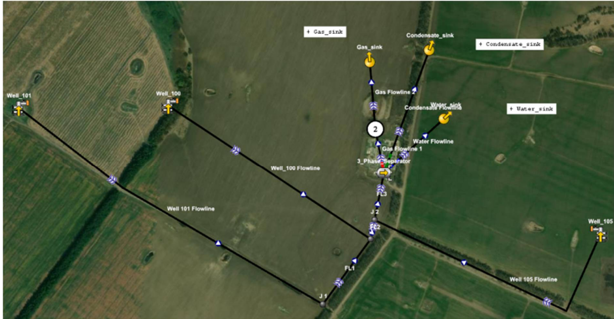
Рис. 4 Розрахункова схема системи збору і підготовки вуглеводнів (GIS map в PIPESIM 2019)
