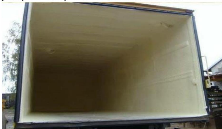
Рисунок 1 - Приклад нанесення пінополіуретану на внутрішні поверхні причепу
